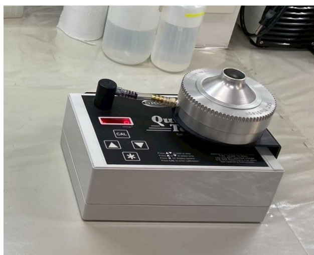
ภาพที่ 5 เครื่องมือในการเก็บตัวอย่างเชื้อจุลินทรีย์ในอากาศ Biostage single-impactor
