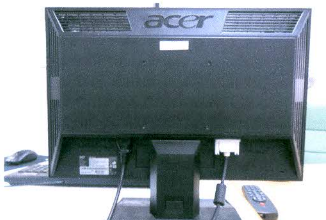
การเชื่อมต่อสายสัญญาณ DVI ด้านหลังจอแสดงผลแอลซีดี
